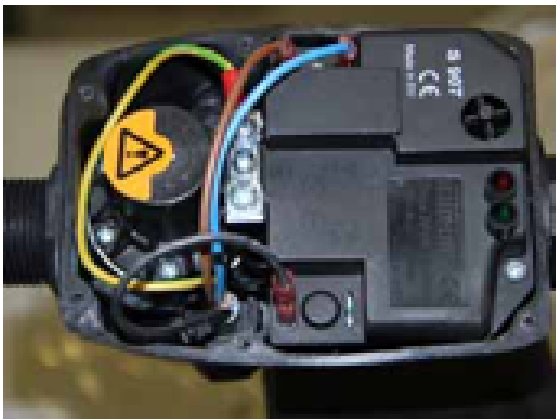
Verbinding pompsturing / basissturing in de klemkast
