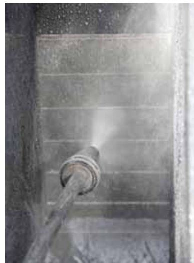
Abb. 16: Zeefreiniging met HD-reiniger
