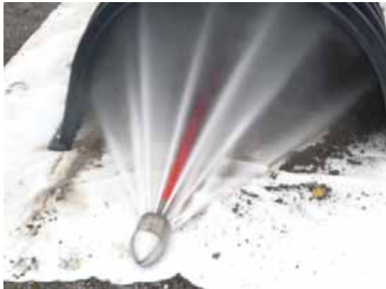
Afb. 10: Reinigingsrat met achterwaartse kegelstraal
