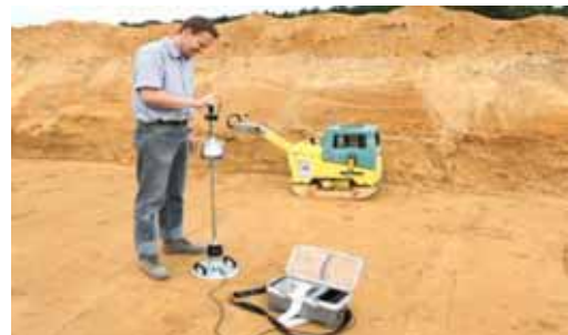
Afb. 27: dyn. Plaatdrukproef op vlakke ondergrond
